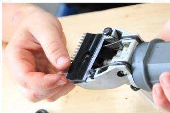
Als Erstes wird das Obermesser mit den Vertiefungen auf die „Zähne“ des Schlittens gelegt. Das Obermesser sollte frei von Dreck und Haaren sein und an den Kontaktflächen zum Obermesser leicht geölt werden.
