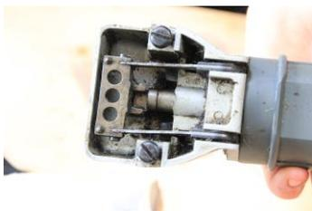
Bevor Schermesser neu eingesetzt oder gewechselt werden, sollte die Schermaschine gesäubert und geölt werden.
