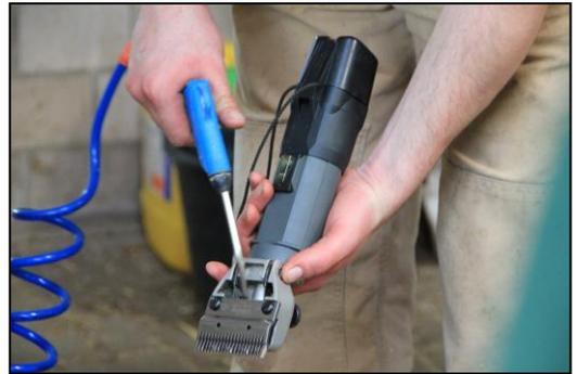
*Schermaschinen sollten nach jedem Gebrauch gesäubert werden. Gegen Haare und Staub im Scherkopf kann z.B. ein Kompressor benutzt werden*
