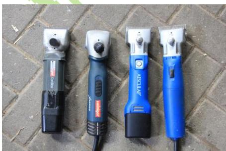
Das Scherblatt einer normalen/großen Schermaschine besteht immer aus einem Ober- und einem Untermesser, die passend zueinander gewählt werden müssen. Da diese Schermesser von verschiedenen Firmen mit unterschiedlichen Bezeichnungen angeboten werden, solltest du dich beim Fachhändler immer nach der Scherlänge erkundigen und erfragen ob die Schermesser auch für deine Maschine geeignet sind. Generell können die Schermesser für große Schermaschinen geschliffen werden, was günstiger ist als
