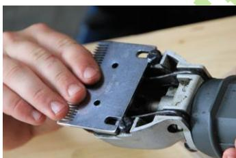
Danach folgt das Untermesser, das in die Halterungsschrauben geschoben wird. Auch das Obermesser sollte sauber sein damit die Maschine ohne „kratzen“ einwandfrei laufen kann.
